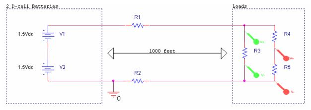
$R1=27.3\Omega$   $R2=27.3\Omega$   $R3=1K\Omega$   $R4=800\Omega$   $R5=400\Omega$
