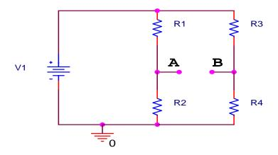
Given: V1=12 V; R1=2 k $\Omega$ ; R2=4 k $\Omega$ ; R3= 8 k $\Omega$ ; R4= 4 k $\Omega$
