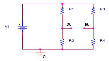
Given: V1=12 V; R1=2 k $\Omega$ ; R2=4 k $\Omega$ ; R3= 8 k $\Omega$ ; R4= 4 k $\Omega$
